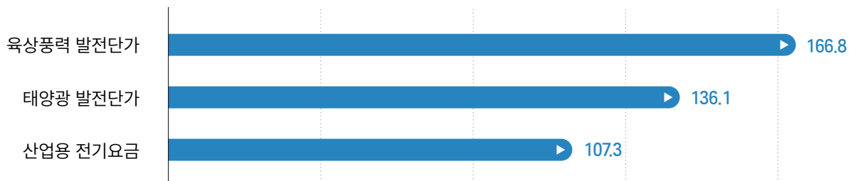
그림 3. 산업용 전기요금 대비 재생에너지 발전단가 비교(2020년 기준, 원/kWh)
